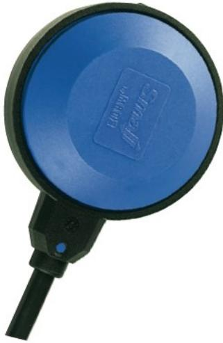
Der Schwimmerschalter **SMALL** eignet sich speziell für Rein- und Schmutzwasser ohne Fäkalien. Für jeden Umschaltpunkt wird ein Schwimmerschalter benötigt. Der Schwimmer bietet eine hohe Sicherheit durch doppelte Isolation und einem zusätzlichen, geerdeten Schutz. Dieser Schutz ummantelt das Gehäuse mit dem Schaltmechanismus und die spannungsführenden Teile.
